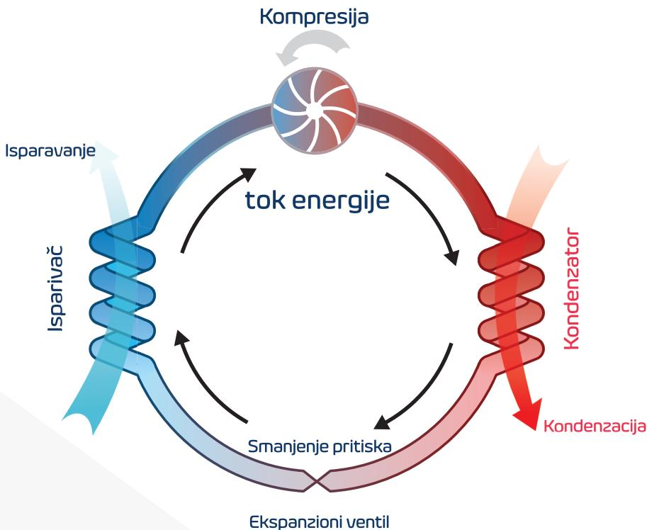
Princip rada toplotne pumpe može se porediti sa principom rada kućnog frižidera ili zamrzivača. Razlika je samo u primarnom cilju koji treba da se postigne pa recimo kod frižidera ili zamrzivača to je hlađenje dok je kod toplotne pumpe grejanje. Svi ovi uređaji imaju identične delove samo je razlika šta je primarno da se iskoristi, da li toplota na kondenzatoru (toplota pumpa) za zagrevanje sistemske vode ili izvlačenje toplote iz okoline na isparivaču (frižider, zamrzivač).
